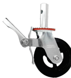
RODÍZIO EMBORRACHADO Cód.: 041 Roda para Andaime 6" Emborrachado 150mm para andaime tubular Diâmetro da Roda 6" (Pol): 152,4mm Largura da Roda 2" (Pol): 50,8mm Diâmetro do tubo (espiga): 32mm Comprimento do tubo (espiga): 150mm Cobertura da Roda: Emborrachada Cubo da Roda: Ferro fundido pintado em preto Roda para Andaime com Trava (freio) Com graxeira para lubrificação
