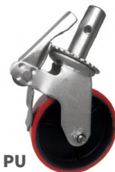
RODÍZIO EMBORRACHADO Cód.: 041 Roda para Andaime 6" Emborrachado 150mm para andaime tubular Diâmetro da Roda 6" (Pol): 152,4mm Largura da Roda 2" (Pol): 50,8mm Diâmetro do tubo (espiga): 32mm Comprimento do tubo (espiga): 150mm Cobertura da Roda: Emborrachada Cubo da Roda: Ferro fundido pintado em preto Roda para Andaime com Trava (freio) Com graxeira para lubrificação
